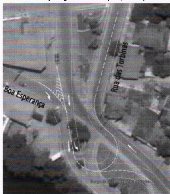
Figura 6.33 – Desenho funcional dos fluxos de tráfego e canalizações
